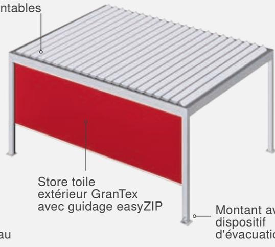
Montant avec dispositif d'évacuation d'eau
